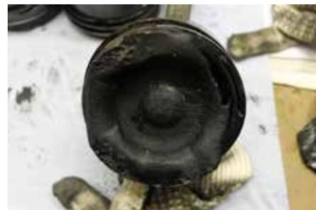
**Оплавление поршня как следствие поломки форсунок**
